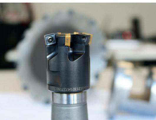
2 So sieht er aus, der Fräser 'Mill 4 Feed' mit fünf vierschneidigen WSP aus der TiAlN-PVD-beschichteten Schneidstoffsorte IC810. Für das Heidelberger-Projekt fiel die Wahl auf eine Sonderausführung mit 39 mm Durchmesser © Iscar
